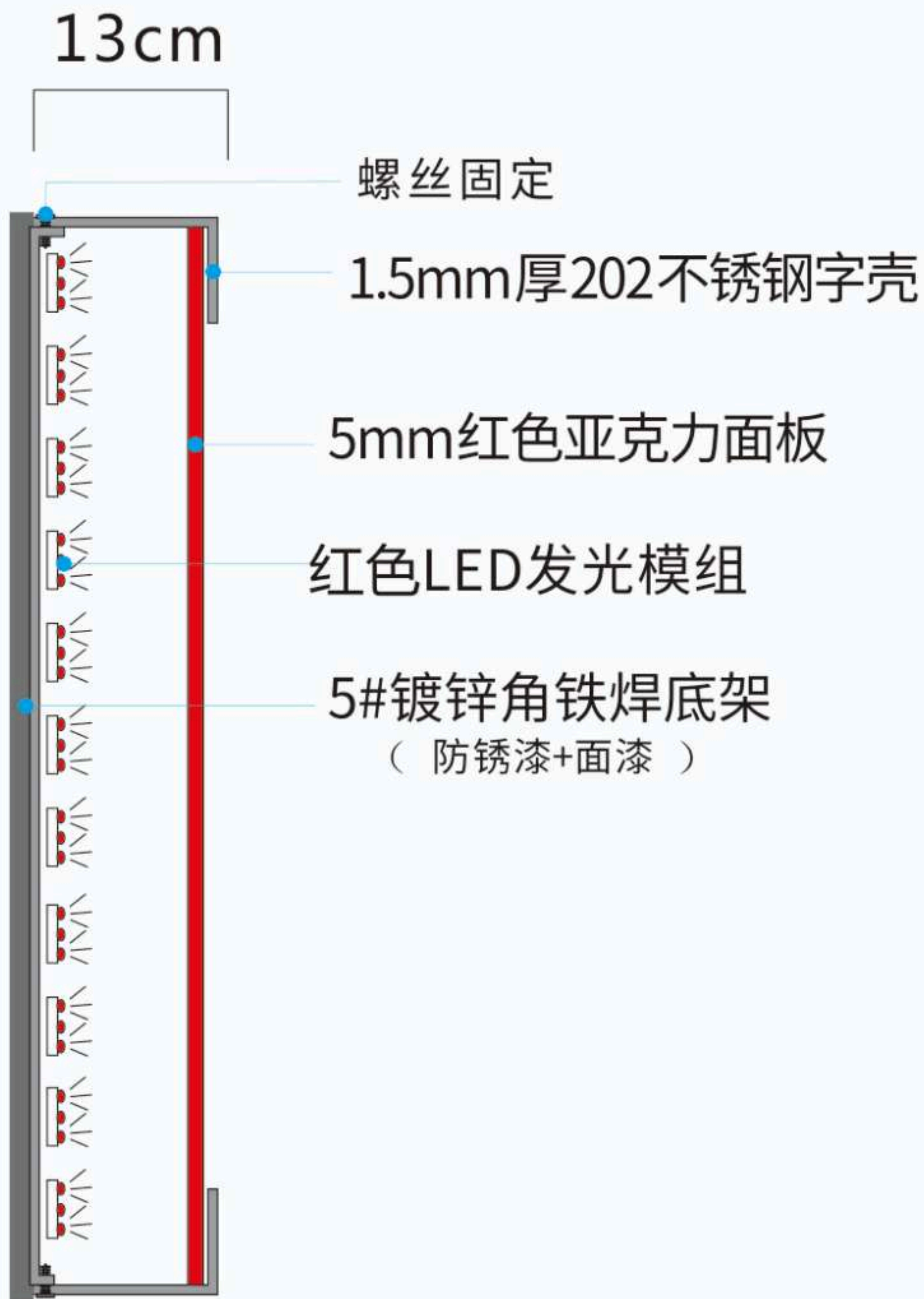
(B) 不锈钢发光字结构示意图
